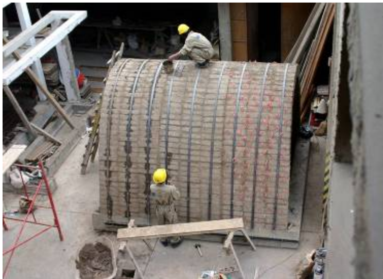
Δοκιμή θολωτής κατασκευής σε σεισμική τράπεζα Πηγή: Gernot Minke
